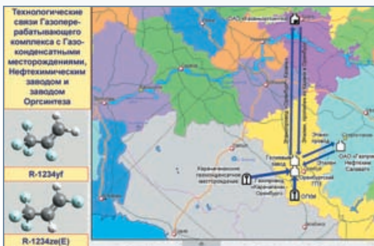
Рис. 5. Производство хладагентов 4-го поколения из продуктов переработки газа на заводе Газоперерабатывающего комплекса
