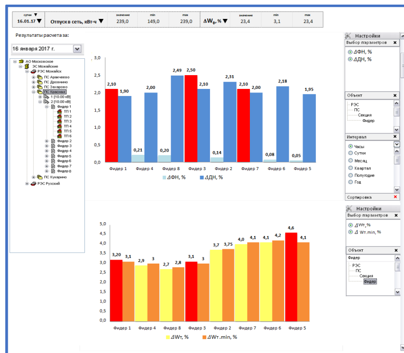
Рисунок 8 - Экранная формы ПТК «РТП 3» системы мониторинга (динамика допустимого и фактического небалансов, фактических технических потерь и минимально возможных технических потерь)
